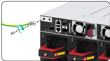
接地线另一端连接到机柜接地点
